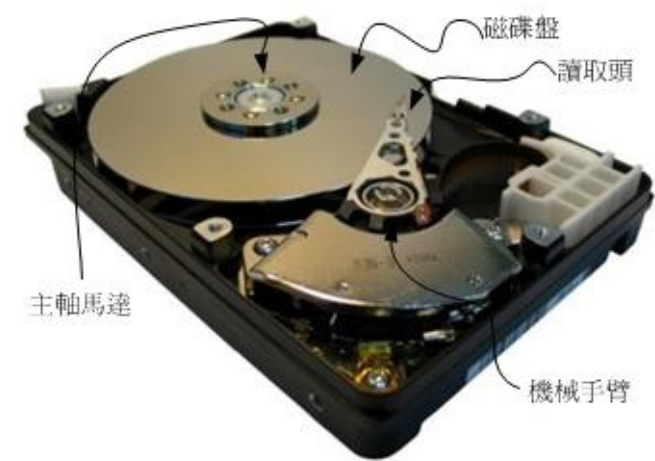
图0.2.4、硬盘物理构造（图片取自维基百科）
